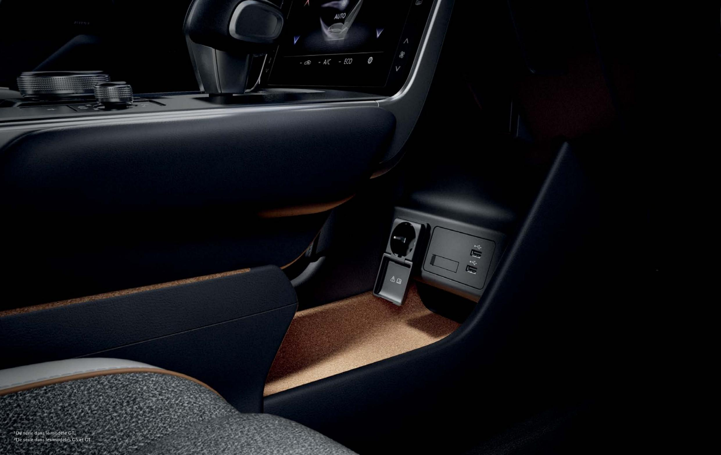
**À gauche :** Prise de courant CA de 120 V 150 W<sup>1</sup> et deux ports USB<sup>2</sup>, sous la console centrale flottante.
